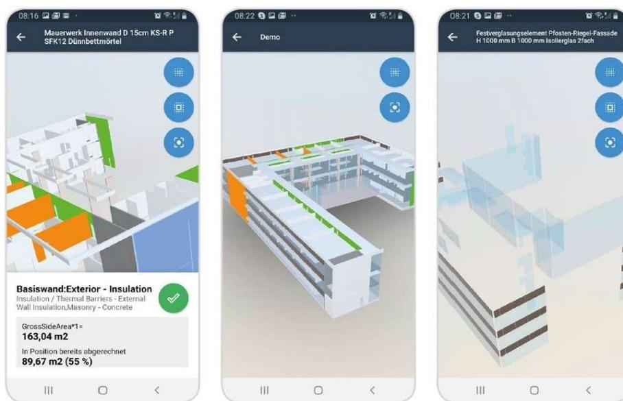
Abbildung 1: App zur digitalen Erhebung und Übermittlung von Bau- und Renovierungsinformationen von Kundenseite, z.B. zur Schadensregulierung / 3D-Messung und Baufortschritt mit BIM<sup>2</sup> Integration (Quelle: NOVA Building IT GmbH 2022).
